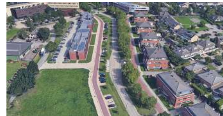
Rúas ciclistas en forma vía de servizo en vías de acceso (Houten, Países Bajos) (Google)
